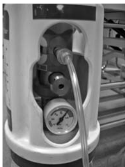
FIGURAS 4 y 5. Caudalímetro adaptado en la bala de gas tras el manorreductor.
