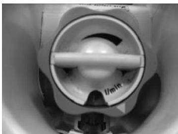
FIGURAS 4 y 5. Caudalímetro adaptado en la bala de gas tras el manorreductor.
