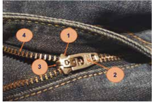
Figura 1. Partes de una cremallera: 1) placa frontal; 2) tirador, 3) barra mediana y 4) dientes.
